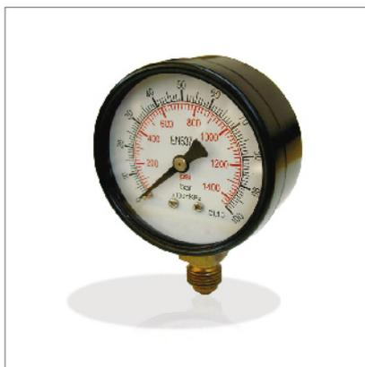
Бурдон Манометр с трубкой, диаметр диска 63 мм, корпус и кольцо в окрашенной стали, латуни движения. Место 1/4" газа М. Различные полная шкала: 10-16-25-40-60-100-250
