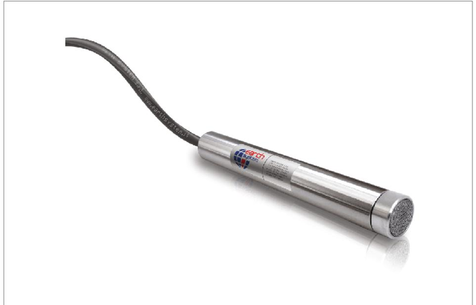
Струнные пьезометры широко используются для измерения промежуточных давлений в грунтах или скальных породах, а также для измерения уровня грунтовых вод. Этот датчик, обладающий высокой прочностью и долговечной надежностью, выполнен из цилиндрического корпуса из нержавеющей стали, внутри которого располагается струнный датчик абсолютного давления, гидравлическая камера и спеченный фильтр.
