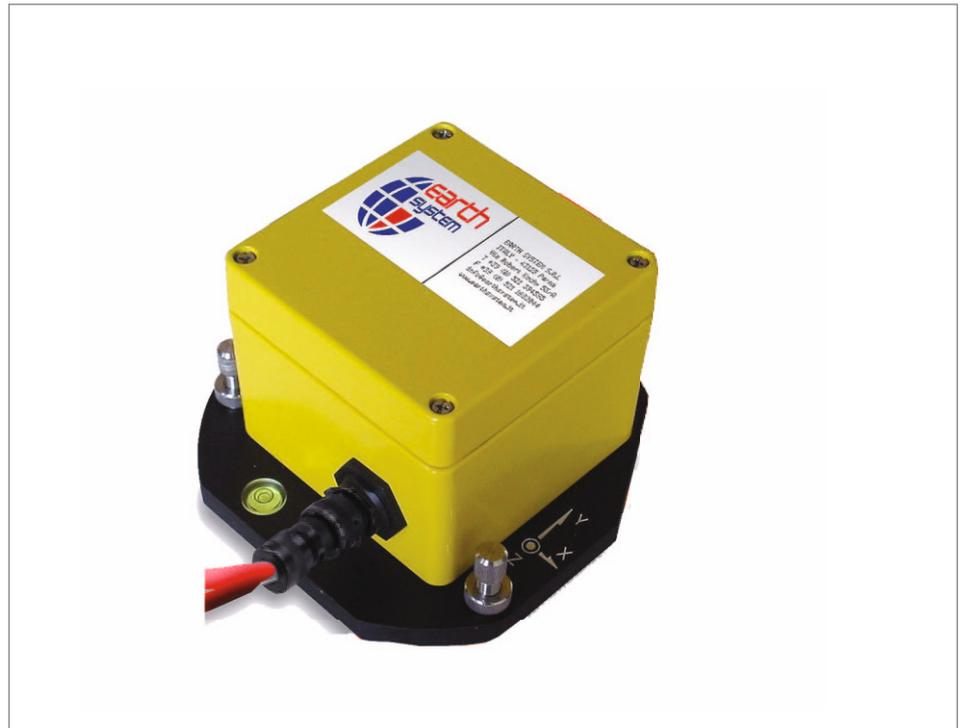
Velocimetro tridirezionale di classe 1 per misure di vibrazioni conformi alle normative DIN4150-3, DIN45669-1, UNI9916 e UNI 9614. E' costituito da terna geofonica linearizzata elettronicamente, con dinamica superiore a 130 dB. Prodotto nelle due versioni per applicazioni verticali o orizzontali e nelle versioni triassiale, biassiale e monoassiale.
