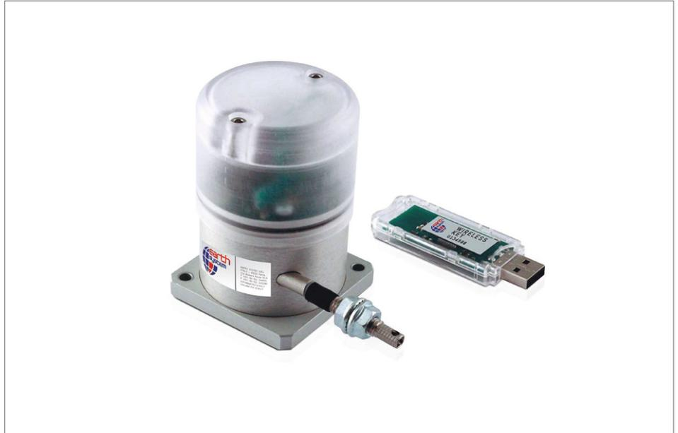
Проволочный тензометр - это прецизионный прибор, используемый для измерения, запоминания и беспроводной передачи значений подвижек разломов, стыков или несущих конструкций. Используется в тех ситуациях, когда необходимы регистрация и передача данных, простота установки и невысокие затраты. Отлично подходит для контроля подвижек в трещинах и несущих конструкциях в труднодоступных
