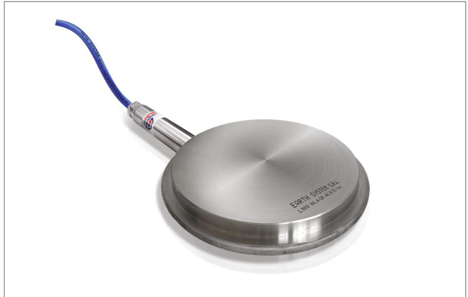
Гидравлическая мессдоза для туннельной дуги - это специальный датчик, изготовленный из двух стальных дисков, сваренных друг с другом по периметру, и разделенные внутри герметичной полостью с не содержащим воздух маслом, обеспечивающим максимальную прочность. Прилагаемая нагрузка передается с помощью масла на
