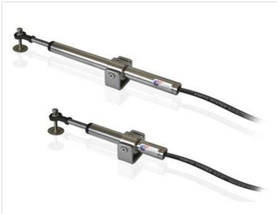
Электрический трещиномер используется для непрерывного измерения раскрытия трещин и раскрытия швов в конструкциях. Датчик состоит из цилиндрического корпуса, внутри находится датчик перемещения с закрепленным к нему стержнем. Датчик преобразует перемещение (раскрытие или сужение) в электрический сигнал. Концы датчика фиксируются при
