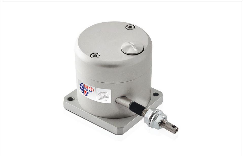
Проволочный тензометр - это прецизионный прибор, используемый для измерения и регистрации данных подвижек разломов, стыков или несущих конструкций. Он используется там, где необходима минимальная заметность, регистрация данных, простота в установке и невысокие затраты.
