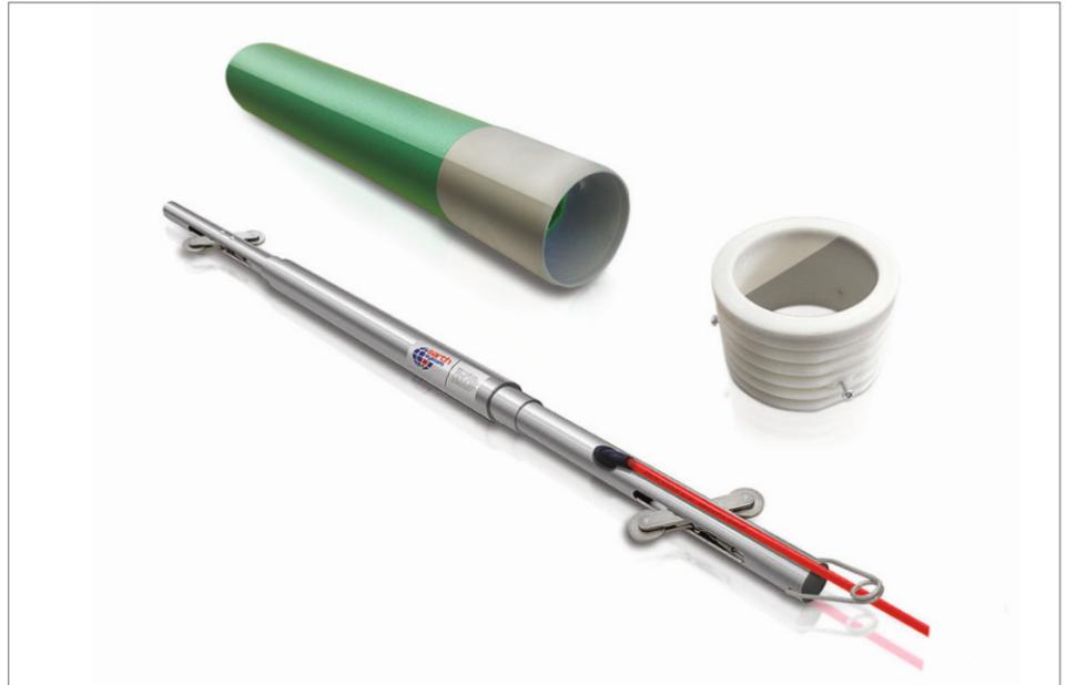
Тензо-инклинометрический зонд - это прибор, разработанный для выполнения планировочных и высотометрических измерений внутри специальных труб с заданной глубиной. Этот прибор состоит из цилиндрического корпуса, выполненного из нержавеющей стали, с колесными каретками для его позиционирования в трубе, внутри которого находятся два перпендикулярно расположенных друг другу датчика и один бесконтактный датчик линейного смещения.
