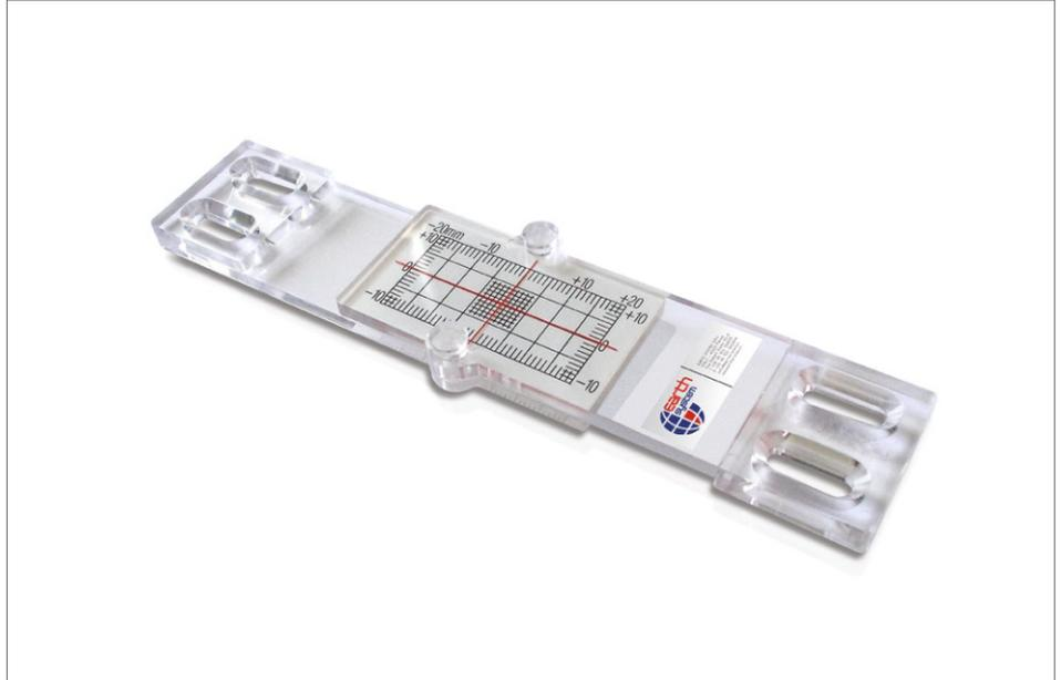
Механический щелемер - это датчик, позволяющий измерять подвижки трещин в кирпиче, цементе или железобетонных конструкциях. Он выполнен из 2 частично наложенных друг на друга пластин, верхняя пластина имеет перекрестие, нижняя имеет сантиметровую и миллиметровую сетку в горизонтальном и вертикальном направлении.
