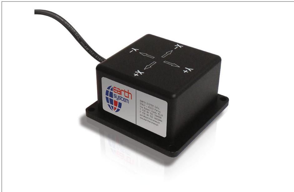
Поверхностный клинометр - это прибор, позволяющий измерять колебания угла наклона конструкции, на которой устанавливается. Широко применяется для мониторинга стен зданий, опор виадуков, подпорных конструкций и скалистых откосов. Состоит из алюминиевого корпуса,
