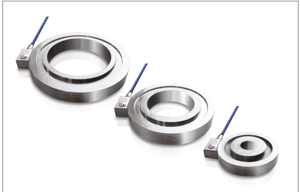
Анкерная мессдоза - это специальный кольцеобразный датчик из нержавеющей стали, используемый в средне- и долговременной проверке натяжения плетеных растяжек и анкерных стержней. В мессдозу встроен ряд тензометров, установленных полным мостом Витстона для подачи электрического сигнала, пропорционального нагрузке, и повышения точности, понижая
