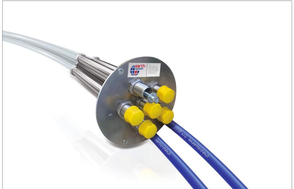
Скважинный стержневой тензометр изготовлен из одного или более стеклопластиковых стержней, на торце которых установлено место измерения из стального прутка с улучшенным прилеганием, глубоко закрепленного в буровых скважинах и свободнодвигающегося внутри кожуха из нейлона rilsan. Стержни жестко передают движение анкеров глубокого заложения по отношению к головке. Такие относительные смещения измеряются обычным измерительным прибором или же могут обрабатываться с
