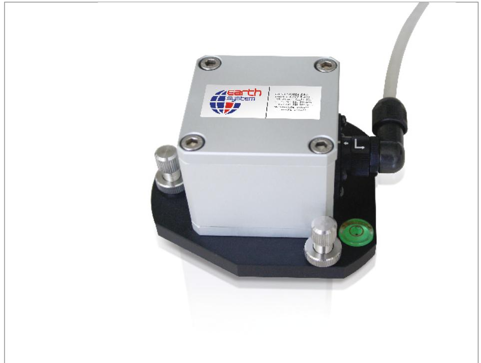
Accelerometro triassiale per applicazioni sismiche nel campo del monitoraggio di strutture e territori. Valida alternativa agli accelerometri "Force Balance", è costituito da una terna di accelerometri MEMS di ultima generazione con bassi "noise", elevata banda di frequenza, bassa distorsione, elevata tolleranza agli shock e stabilità termica ed è ideale per il monitoraggio di strutture e misure accelerometriche in genere.
