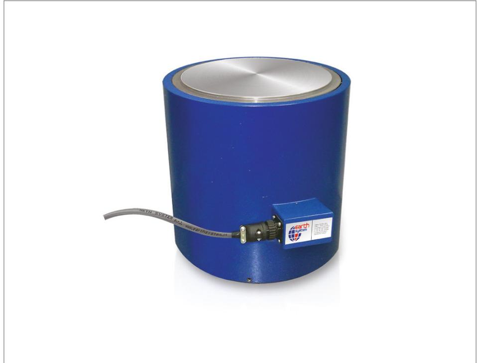
Данные мессдозы используются главным образом для выполнения испытаний нагрузкой и для установок особого назначения. Мессдозы состоят из цилиндрического стального корпуса со встроенным рядом тензометрических датчиков,
