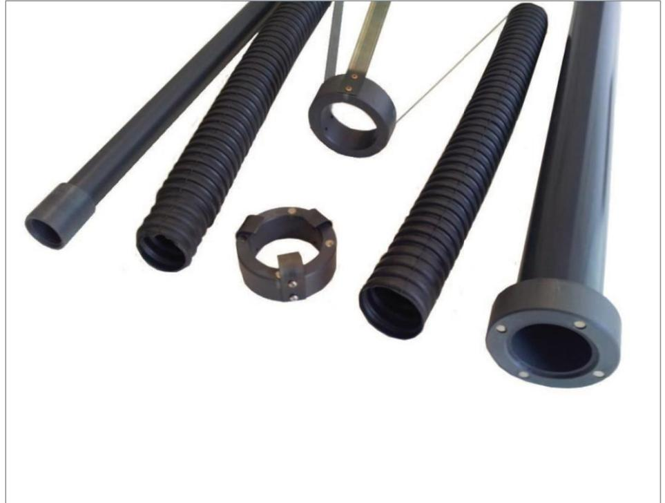
Магнитный прибор используется для мониторинга объема осадки или подъема грунта, вследствие строительства плотины, насыпи, эскаваторных и земляных работ. В состав прибора для измерения осадок входят:
