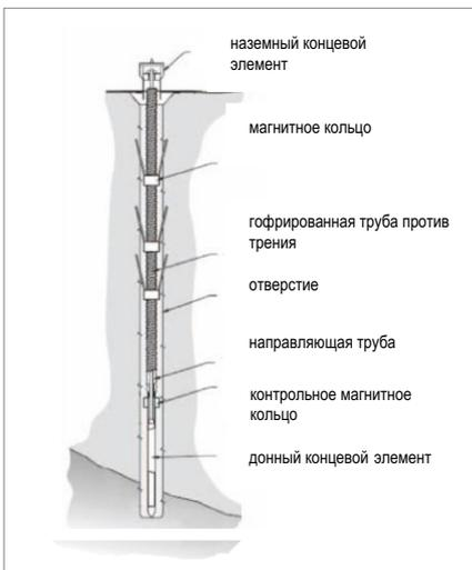
Схема магнитного прибора для измерения осадок
