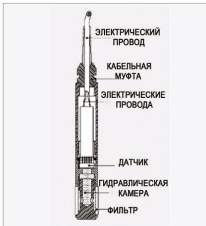
Схема электрического пьезометра
