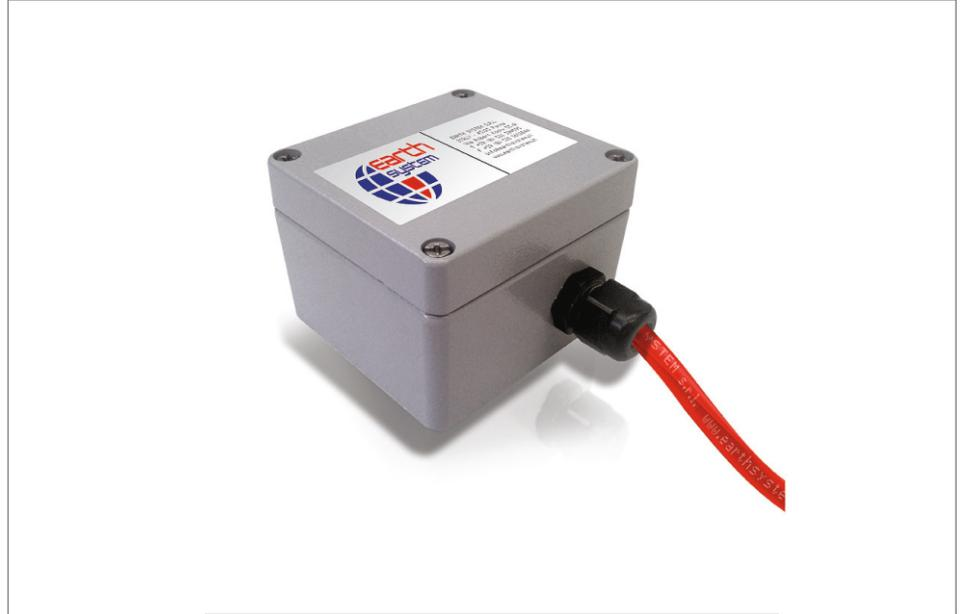
Электроуровнемер - это высокоточный прибор с небольшим диапазоном измерения, позволяющий измерять наклон конструкции, на которой установлен. Электроуровнемер находит широкое применение в мониторинге стен зданий и опор виадуков. Состоит из алюминиевого корпуса, содержащего датчики, по одному на каждую
