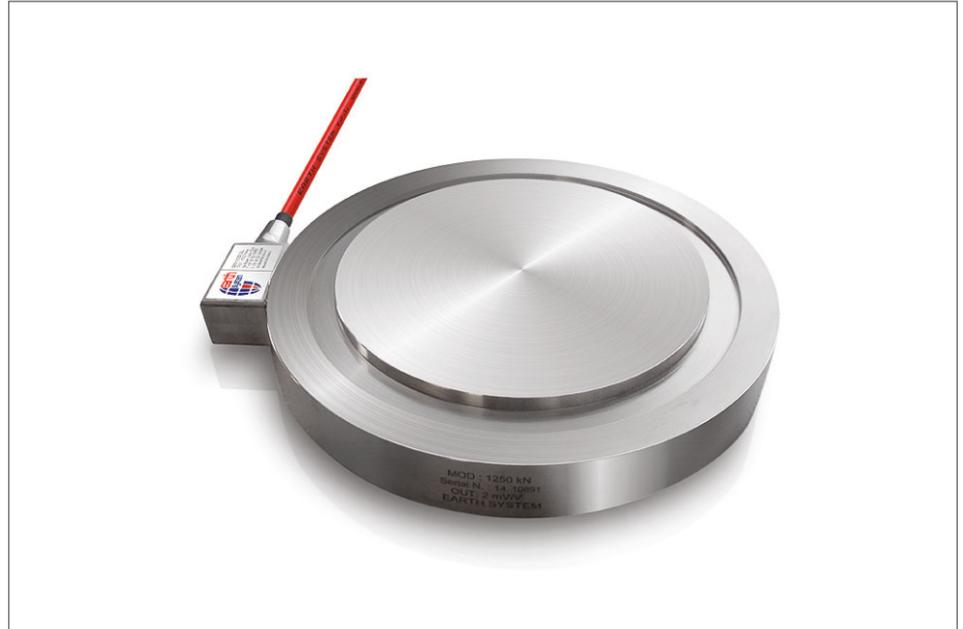
Электрическая мессдоза для туннельной дуги - это особенный датчик с цилиндрическим стальным корпусом со встроенным рядом тензометрических датчиков, установленных полным мостом Витстона для подачи электрического сигнала, пропорционального нагрузке, повышающего точность, снижающего
