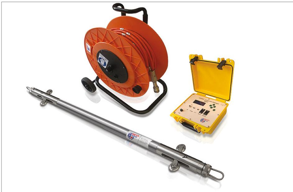
Эта система используется в мониторинге оползней, плотин, перегородаков, котлованов, нестабильных откосов, дамб, а также в измерении горизонтальных подвижек грунта в самом широком плане. Данное инклинометрическое измерение осуществляется путем введения зонда с двухосевым акселерометром MEMS в инклинометрическую трубу, помещенную в вертикальную геологоразведочную скважину. Это позволяет определить значение
