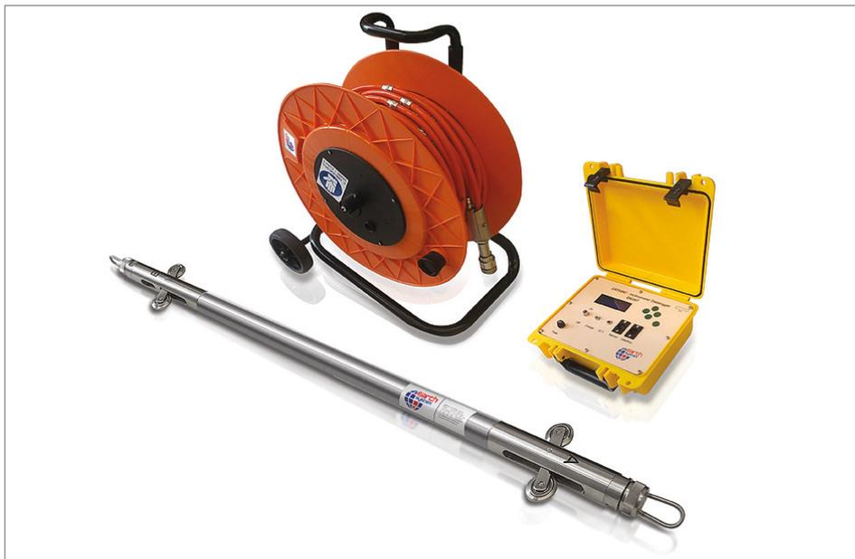
Эта система используется в мониторинге оползней, плотин, перегородок, котлованов, нестабильных откосов, дамб, а также в измерении горизонтальных подвижек грунта в самом широком плане.
