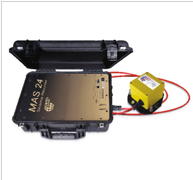
L'unità integrata ad alta risoluzione ( 24 bit di campionamento e dinamica > 130 db ) a 3 o 6 canali e in grado di operare come acquisitore vibrazionale o sismico/microsismico nel rispetto delle normative di riferimento internazionali DIN4150-3, DIN45669-1 e UNI9916.
