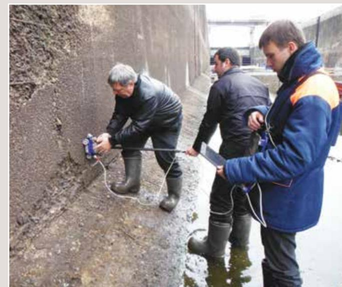
Георадиолокационное обследование стены антенной АБ-1700
