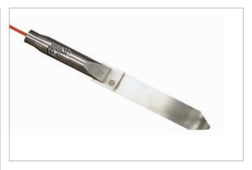
Забиваемый датчик давления, называемый также датчик-лопата, предназначен для его помещения в грунт, где он используется для измерения общего давления как самого грунта, так и давления воды.
