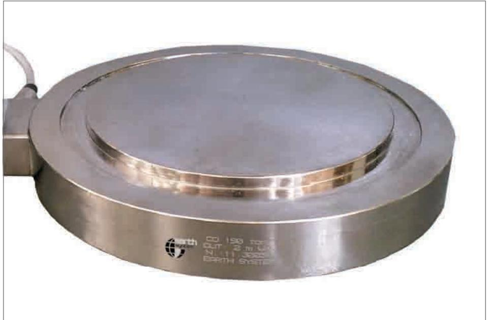
Электрическая мессдоза для туннельной дуги - это особенный датчик с цилиндрическим стальным корпусом со встроенным рядом тензометрических датчиков, установленных полным мостом Витстона для подачи электрического сигнала, пропорционального нагрузке,
