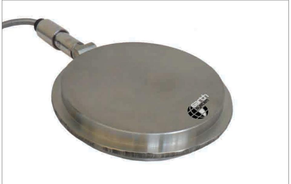
Гидравлическая мессдоза для туннельной дуги - это специальный датчик, изготовленный из двух стальных дисков, сваренных друг с другом по периметру, и разделенные внутри герметичной полостью с не содержащим воздух маслом, обеспечивающим максимальную прочность. Прилагаемая нагрузка передается с
