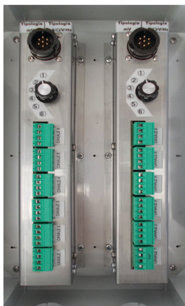
Шкаф с 2 панелями централизации (12 инструментов)
