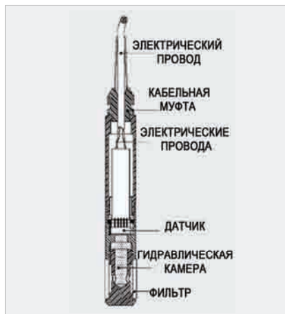
Схема электрического пьезометра
