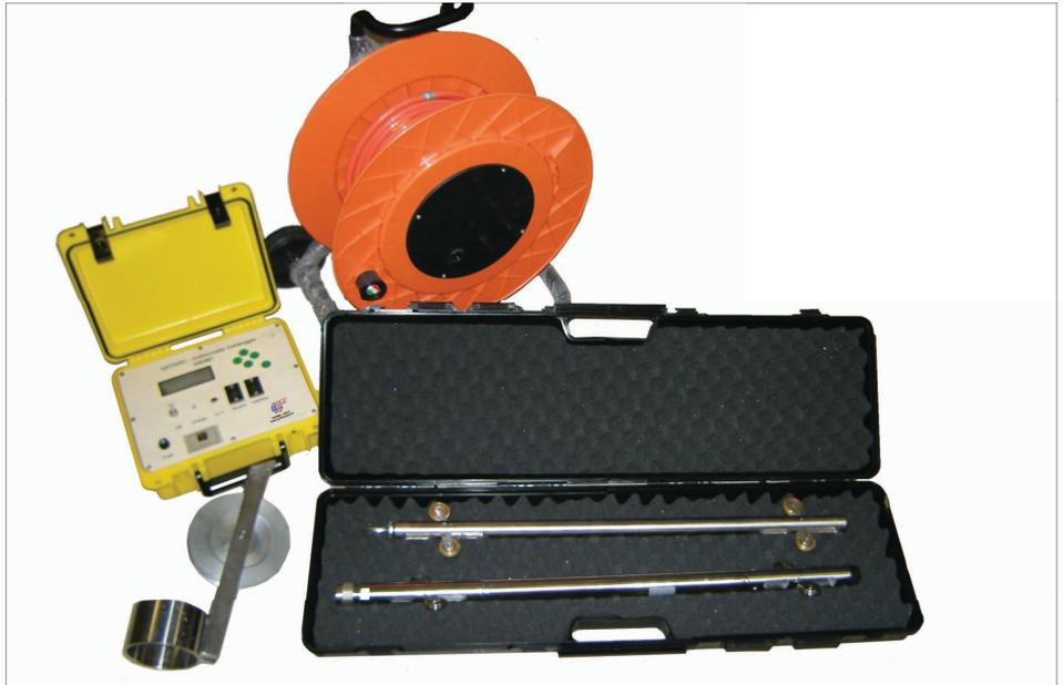
Эта система используется в мониторинге оползней, плотин, перегородок, котлованов, нестабильных откосов, дамб, а также в измерении горизонтальных подвижек грунта в самом широком плане. Данное инклинометрическое измерение осуществляется путем введения зонда с двухосевым акселерометром MEMS в инклинометрическую трубу, помещенную в вертикальную геологоразведочную скважину. Это позволяет определить значение наклона трубы и с течением
